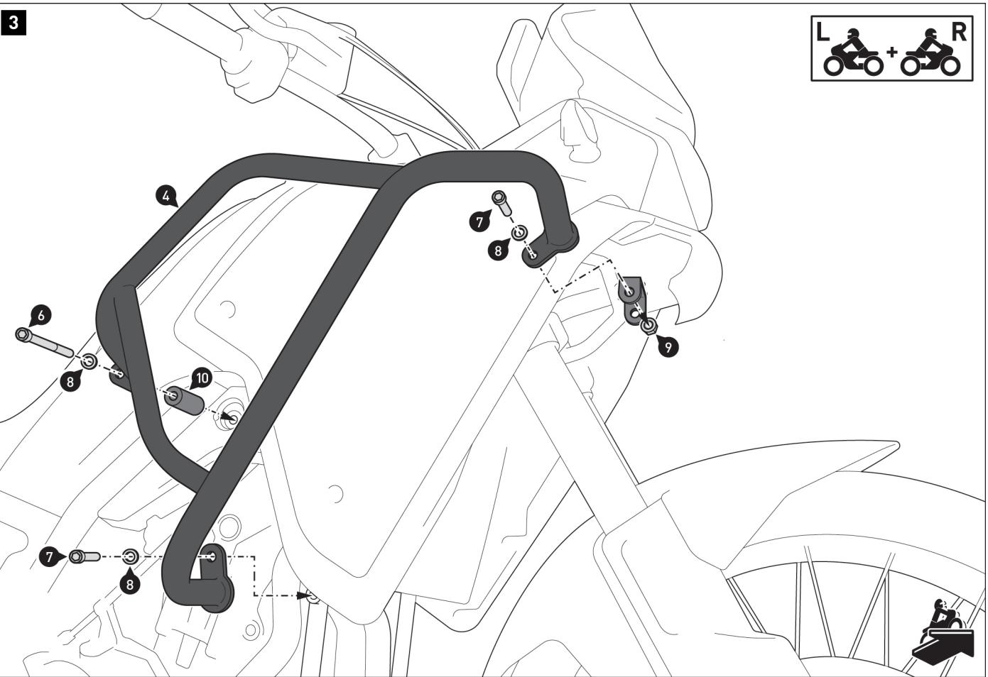
Avvitare le metà delle barre di protezione (4/5) su entrambi i lati del veicolo.
