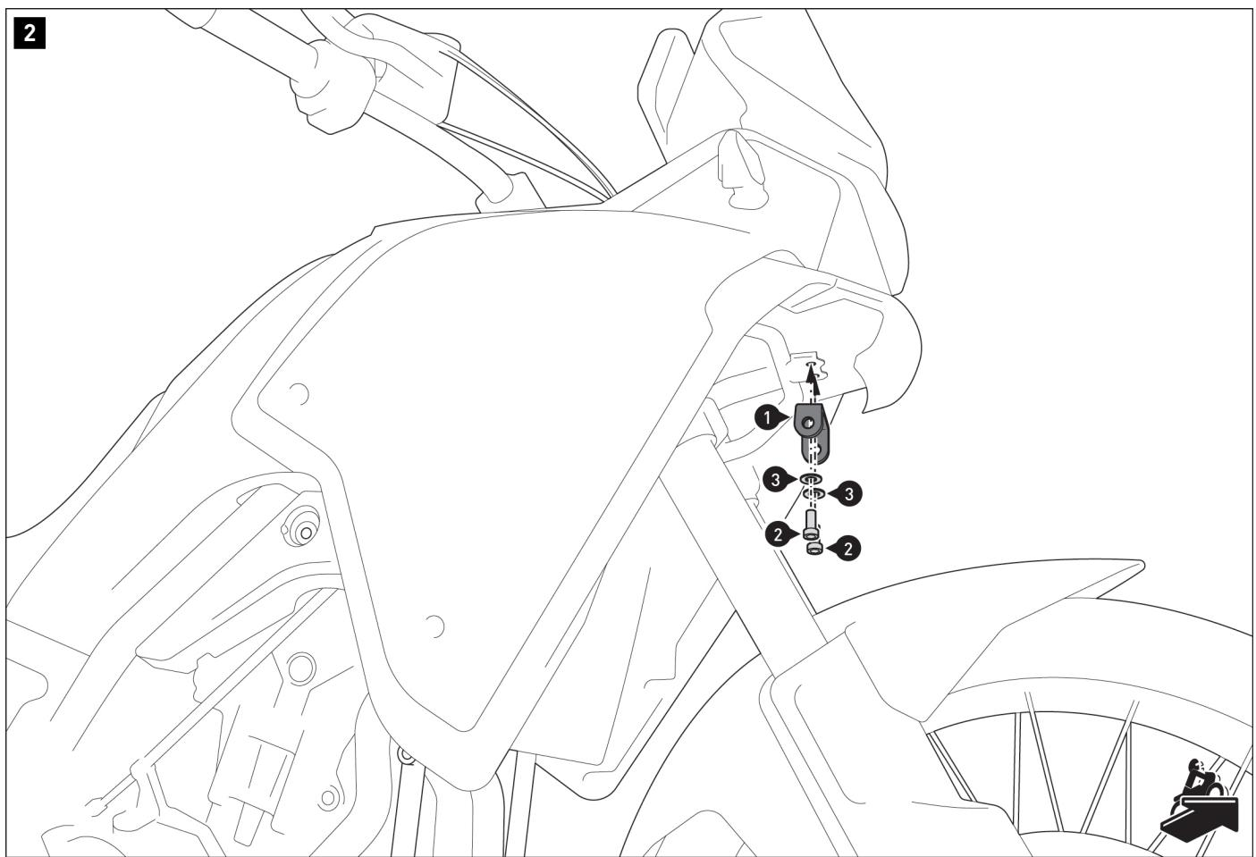
Montare la piastra di fissaggio (1) sul veicolo
