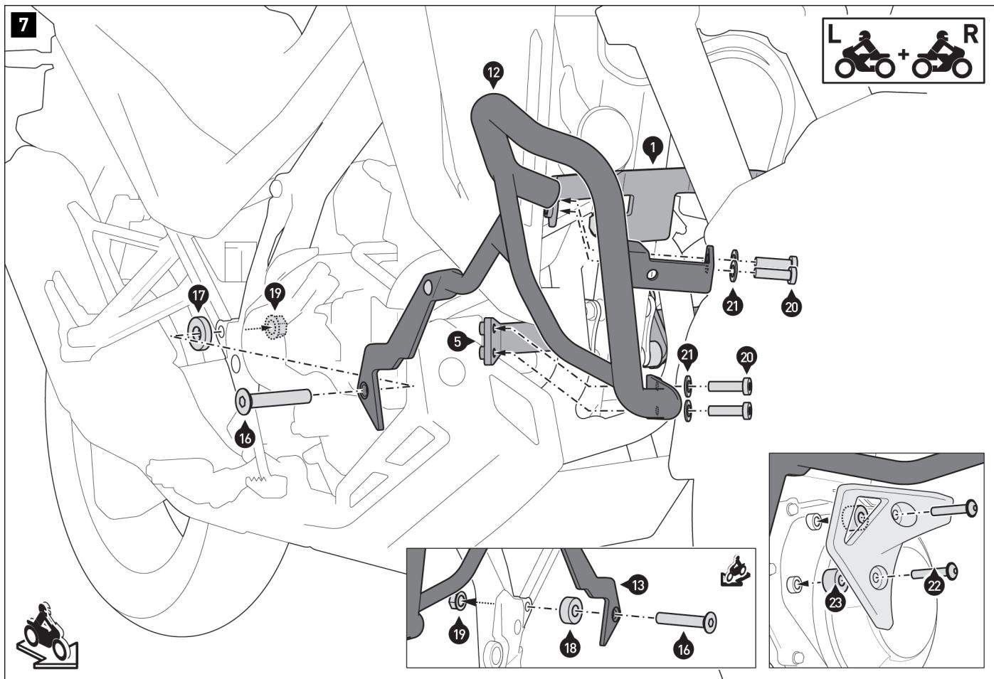
Avvitare al veicolo le barre di protezione (12/13), la barra di congiunzione (1) e i montanti di fissaggio (4/5).
