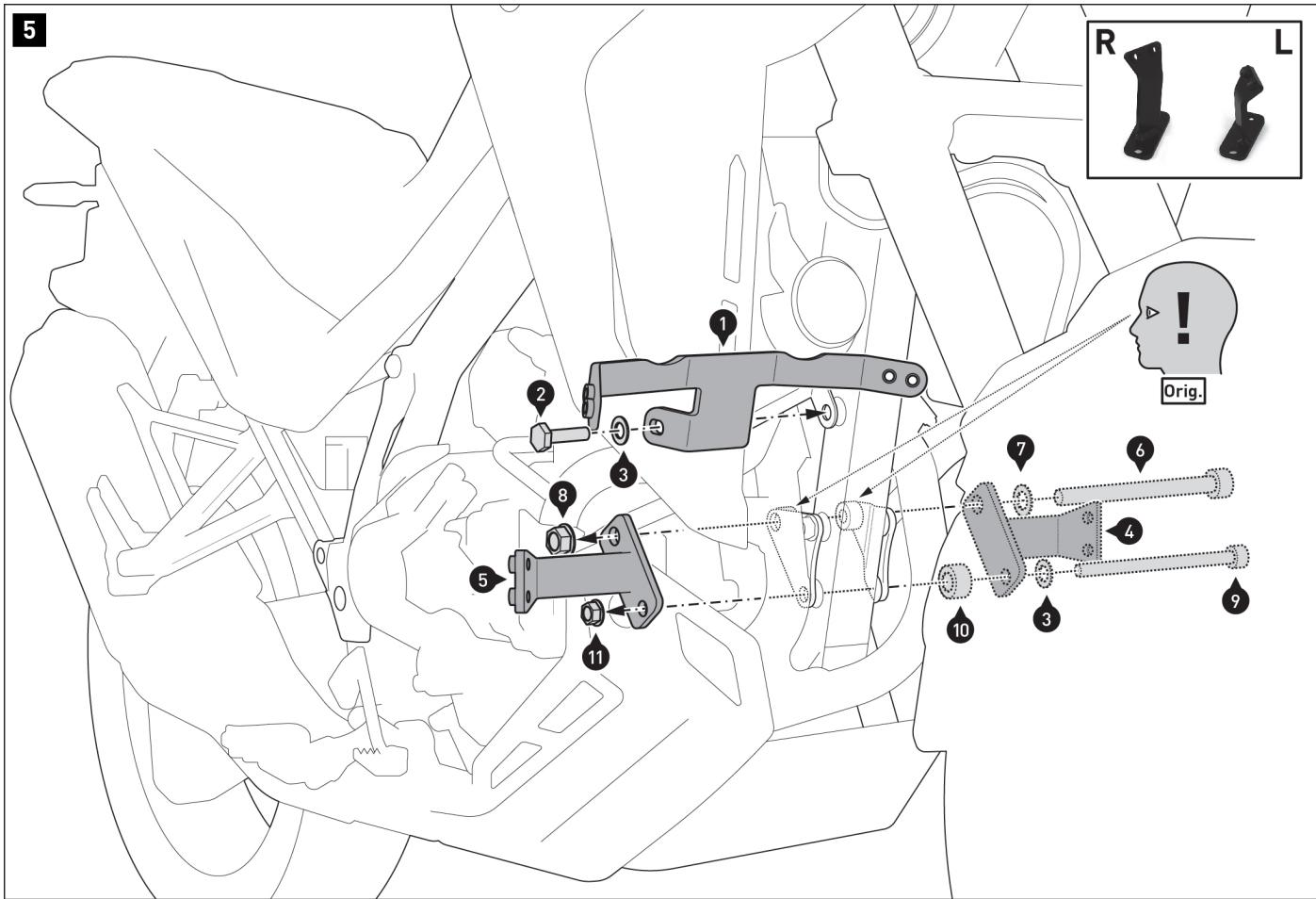
Montare la barra di congiunzione (1) e i montanti di fissaggio (4/5) al telaio del veicolo.
