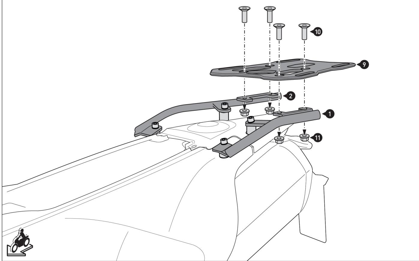
Montare il portabagagli (9) sul montante di fissaggio (1) e (2).
