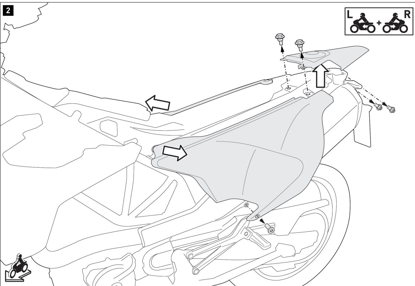
Allentare le viti dai punti di fissaggio indicati e rimuovere le parti della carrozzeria dal veicolo.
